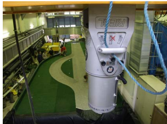
Terrestrischer Laserscanner LMS Z420i der Firma Riegl beim Scannen des Modells
